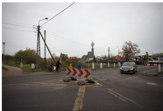
Fot. 18. po lewej i fot. 19. po prawej: miejsce problemowe – skrzyżowanie Via Ambra 2010 biegnącej wzdłuż DK 91 (ul. Grunwaldzka) z ul. Raciborskiego. Brak oznakowania kolorem drogi rowerowej, Przejście przez ulicę dodatkowo utrudnia brak sygnalizacji świetlnej oraz intensywny ruch samochodowy
