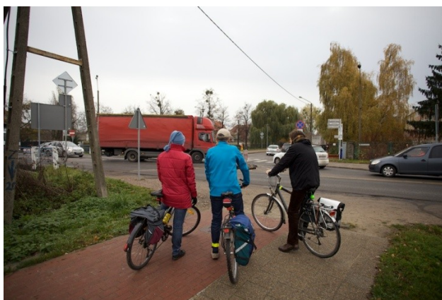
Fot. 18. po lewej i fot. 19. po prawej: miejsce problemowe – skrzyżowanie Via Ambra 2010 biegnącej wzdłuż DK 91 (ul. Grunwaldzka) z ul. Raciborskiego. Brak oznakowania kolorem drogi rowerowej, Przejście przez ulicę dodatkowo utrudnia brak sygnalizacji świetlnej oraz intensywny ruch samochodowy
