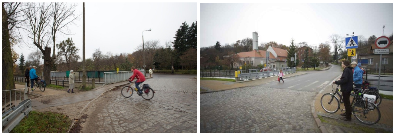
Fot.14 po lewej i fot. 15. po prawej: skrzyżowanie korytarza ruchu rowerowego na Trakcie Św. Wojciecha jedną z przecznic. Bark ciągłości oznaczenia ścieżki rowerowej zarówno na jezdni jak na chodniku. Także krawężniki nie są zniwelowane.
